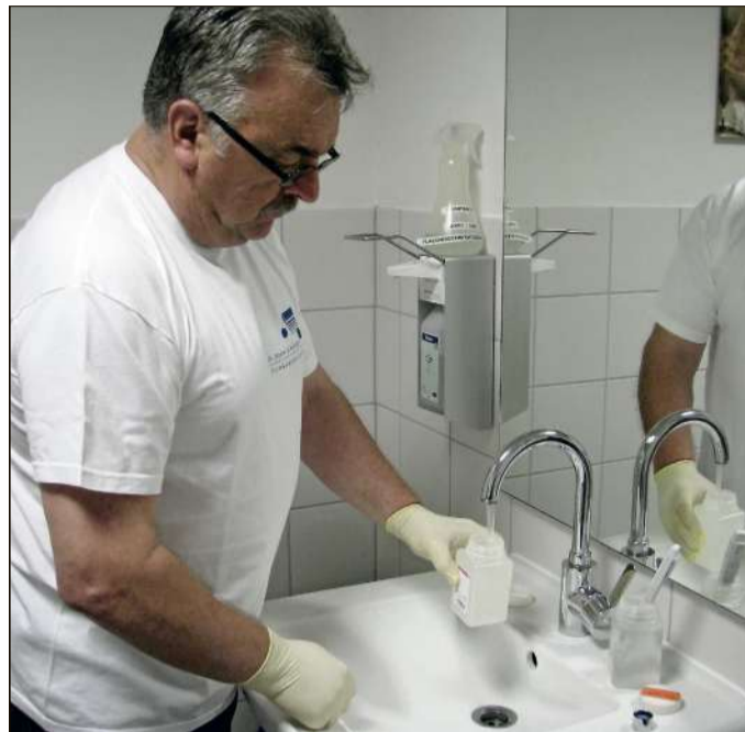
Norbert Hauptvogel entnimmt eine Probe, um das Trinkwasser auf Legionellen zu testen. Foto: Franz
